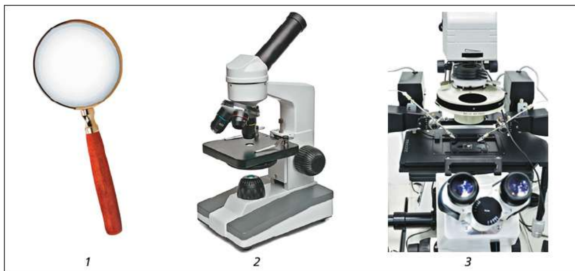
Рис. 4. Увеличительные приборы: 1 — лупа; 2 — оптический микроскоп; 3 — электронный микроскоп
